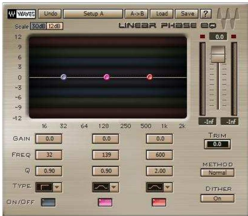
Данные эквалайзеры являются многополосными и исключают какие-либо фазовые искажения. В левой части окна эквалайзеров располагается переключатель **Scale**. Можно установить пределы диапазона отображаемых уровней частот либо  $\pm 12\text{dB}$ , либо  $\pm 30\text{dB}$ . В правой нижней части окна эквалайзеров имеются две кнопки:
