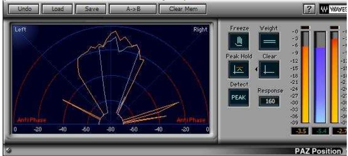
В этом плагине наблюдается стереополе, т.е. отображении мгновенного распределения энергии каждого из источников звука по стереопанораме и выявлении противофазных компонентов, влияющих на моносовместимость звукового сигнала. Длинна линии на графике соответствует громкости, а угол наклона линии есть стереопозиции. Если линия направлена вертикально вверх, значит сигнал монофонический. Слева также имеется измеритель уровня – **PAZ Meters**.
